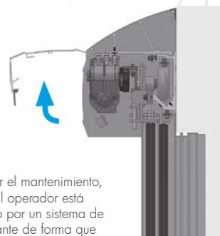
Para facilitar el mantenimiento, el acceso al operador está simplificado por un sistema de capó pivotante de forma que pueda quedar abierto durante el tiempo de la intervención.
